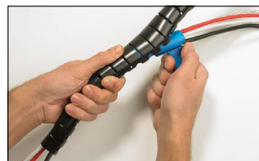
3) Puxe a ferramenta de aplicação de forma que os cabos fiquem dentro do Helawrap.
