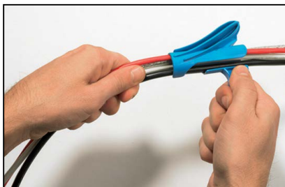
1) Junte todos os cabos e introduza-os na ferramenta de aplicação.
